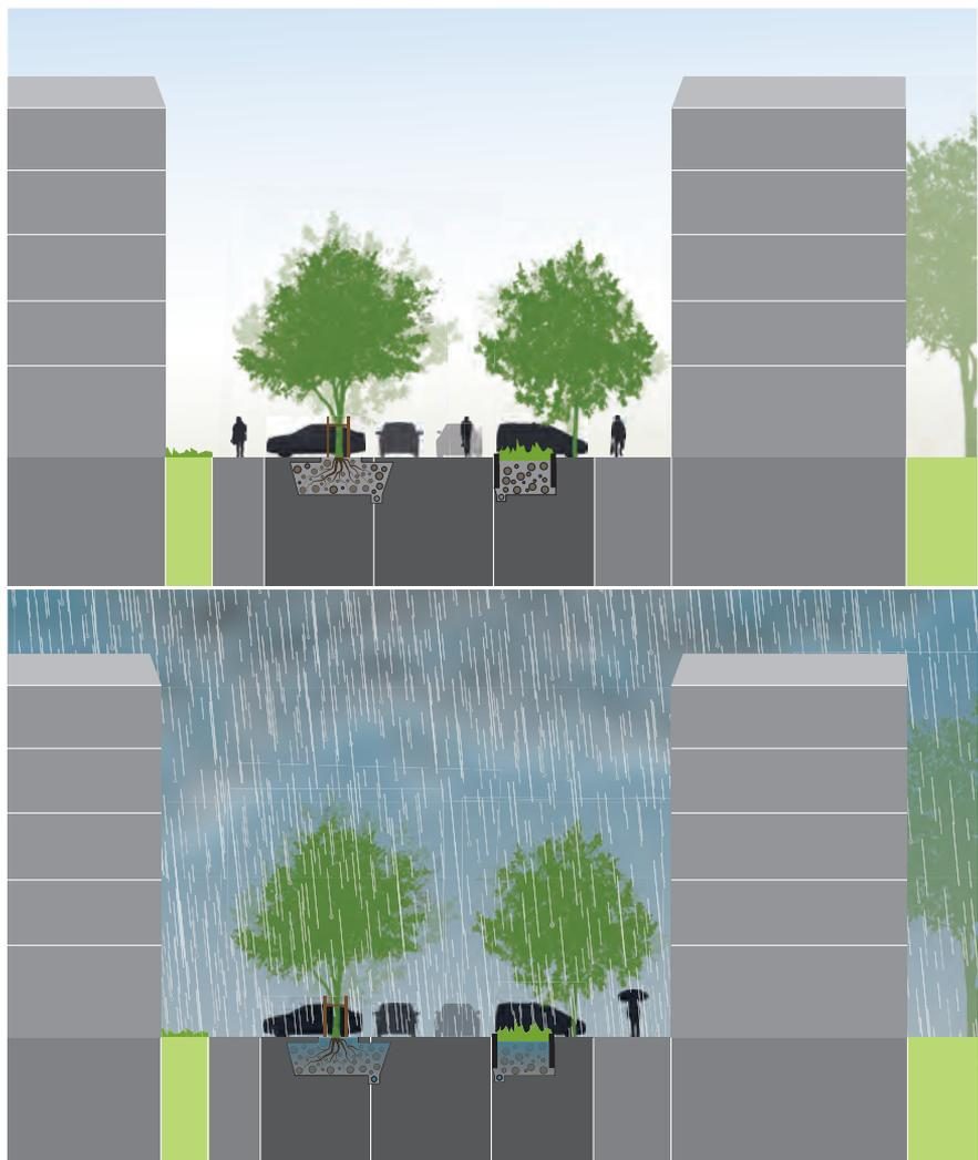
Abb. 4: Begrünte Straßen bei Sonne und bei Regen mit versickerungsfähigen Pflanzgruben von Straßenbäumen und Tiefbeeten
